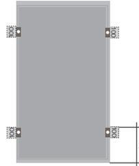
Max. zulässige Drucklast bis 4.200 Pa (Testlast 6.300 Pa)
