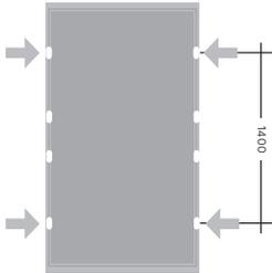
Max. zulässige Drucklast bis 2.400 Pa (Testlast 3.600 Pa)
